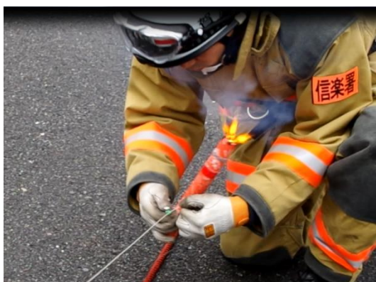
写真12 ワイヤロープに発炎筒を取付ける状況
