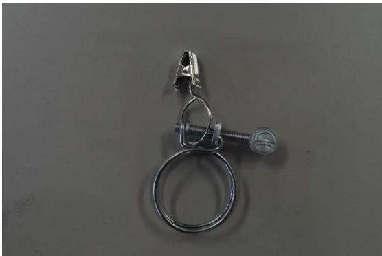
写真6 ホースバンドとリングクリップの接続状況
