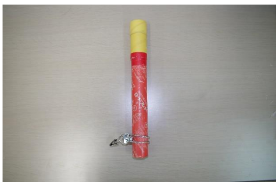
写真9、写真10 ホースバンドと発炎筒を固定した状態
